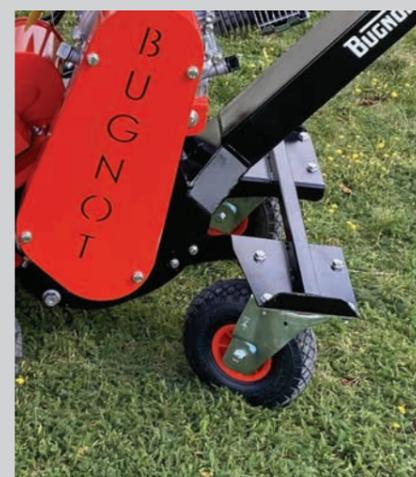
Option roues pivotantes avant ∅ 260 mm
