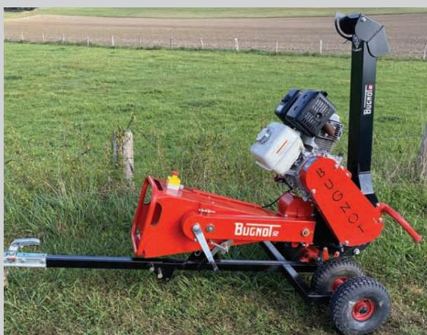
Option flèche de transport repliable et démontable avec essieu élargi pour quads ou micro tracteurs (uniquement sur Glouton)
