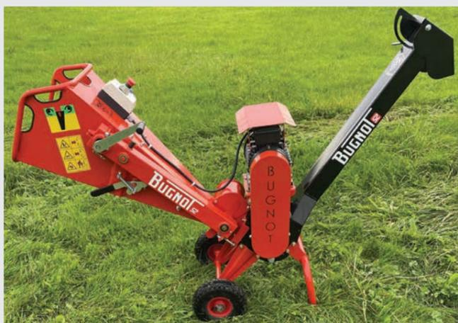
Accès facile au rotor par simple basculement de la trémie
