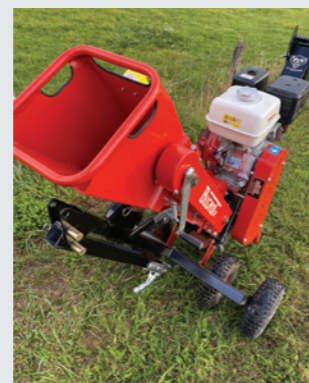
Option flèche de transport repliable et démontable avec essieu élargi pour quad ou micro tracteurs
