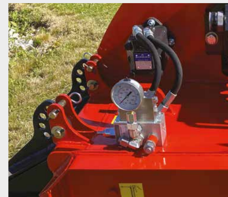
L'entraînement du rouleau ameneur se fait par un moteur hydraulique de 315 cm 3 (30l/min et 180 bar maxi) alimenté par le tracteur ou l'enjambeur, un clapet de surpression assure le fonctionnement en continu du rouleau ameneur avec une fonction go et return (en cas de bouchage le rouleau ameneur se met automatiquement à tourner à l'envers pendant quelques secondes afin d'assurer le débouchage de celui-ci pour éviter l'arrêt du broyage)
