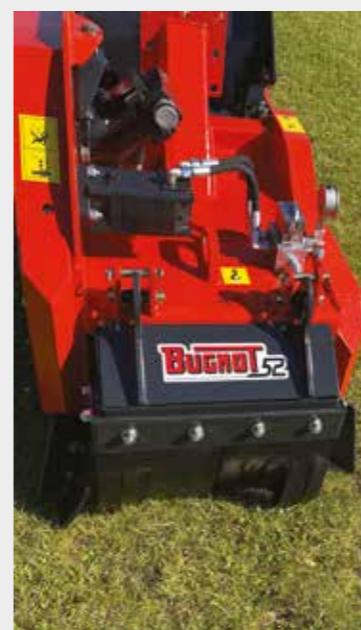
A l'avant du broyeur un capot réglable en hauteur et garni de bandes en caoutchouc permet d'éviter des projections de pierres vers la vigne
