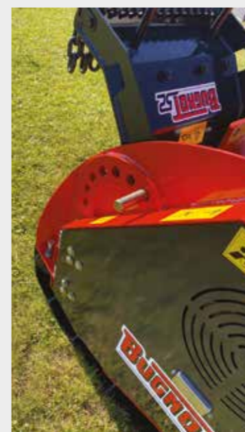
Réglage de la position du capot arrière par broche (hydraulique en option)
