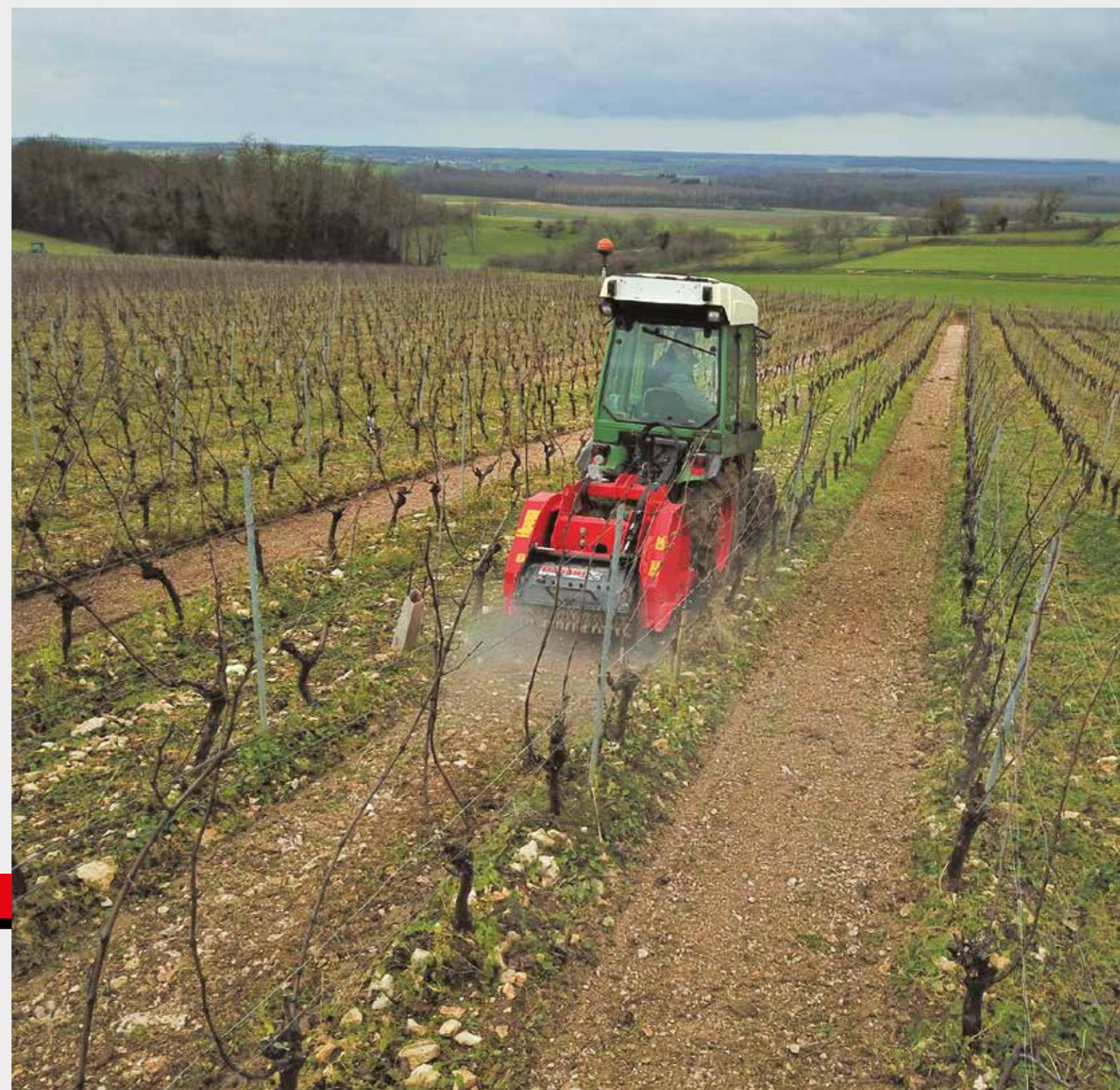
BFLSE 680 pour enjambeur, largeur de rotor 50 cm, largeur hors tout 68 cm. Moteur hydraulique 63 cm 3 , débit de 60 à 120l/min et maxi 400 bar
