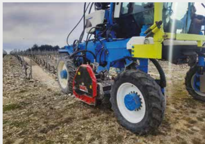
Entraînement hydraulique et montage sur enjambeur soit au centre soit entre les roues sur le côté
