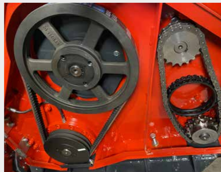
Poulies et courroies XPB pour l'entraînement du rotor
