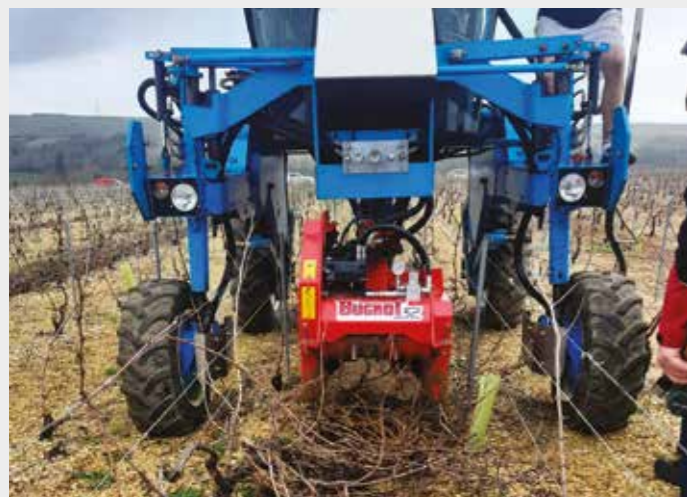
Entraînement hydraulique et montage sur enjambeur soit au centre soit entre les roues sur le côté
