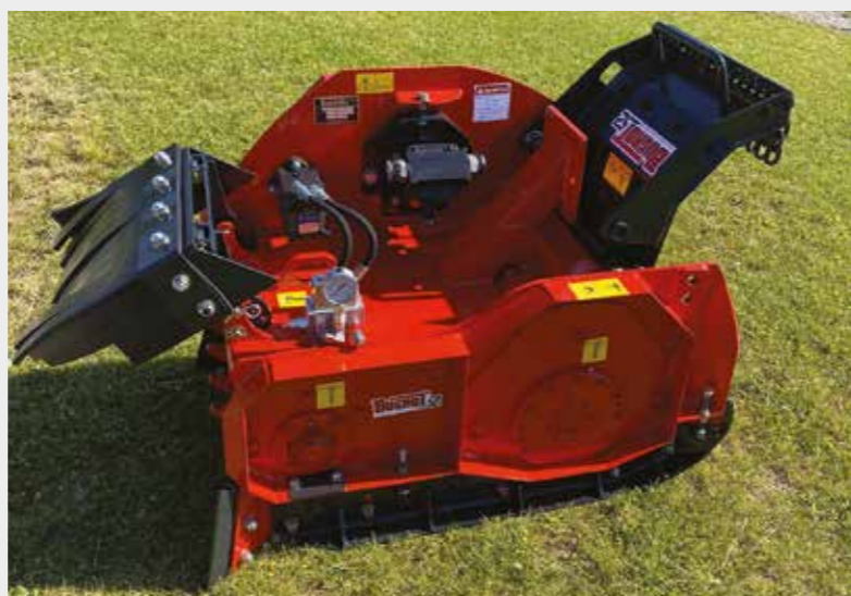
BFLSE 680 pour enjambeur, largeur de rotor 50 cm, largeur hors tout 68 cm. Moteur hydraulique 63 cm 3 , débit de 60 à 120l/min et maxi 400 bar
