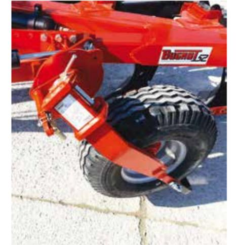
Roue synchronisée hydrauliquement au retournement
