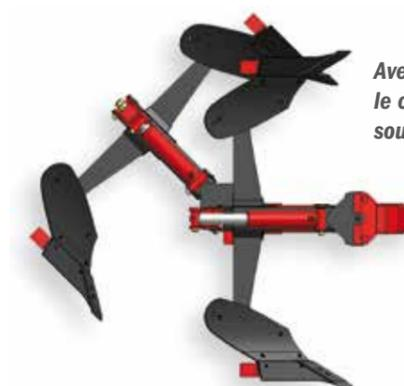
Avec sécurité boulon ou hydraulique, le corps se dégage de l'obstacle sans soulever la charrue.
