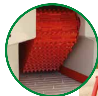
Pour une plus grande facilité de chargement, ameneur supérieur et tapis ameneur inférieur de série CBB 300 et 300A (en option sur CBB 220 et 220A)
