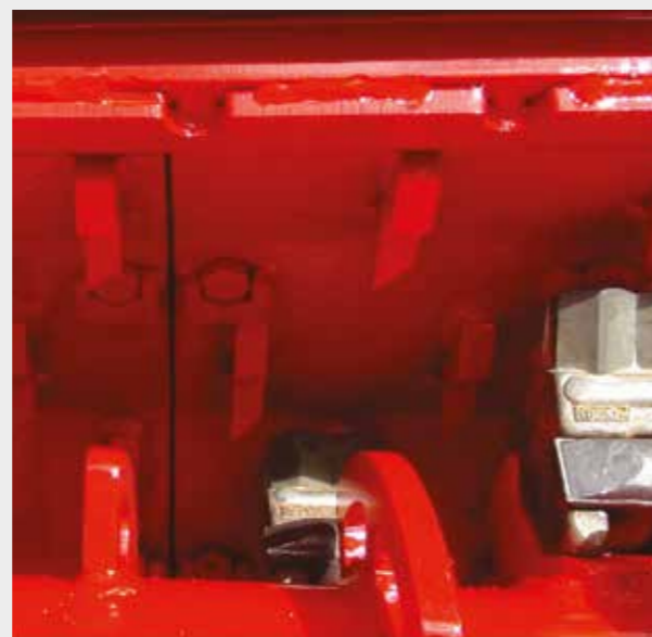
Chambre de broyage avec éclateurs
