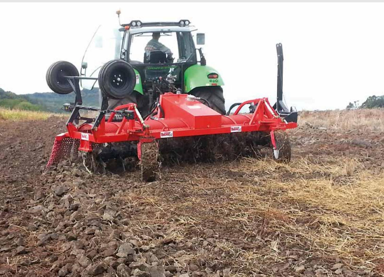
Toutes les aligneuses sont équipées de roues de contrôle auto-alignantes. Le réglage d'angle de la machine est toujours hydraulique.
