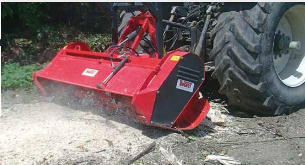
L'orientation hydraulique du rotor permet de faire varier sa position de - 3 cm à + 30 cm sans changer les angles de cardan
