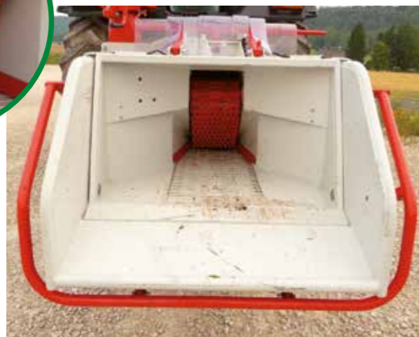
Pour une plus grande facilité de chargement, ameneur supérieur et tapis ameneur inférieur de série CBB 300 et 300A (en option sur CBB 220 et 220A)
