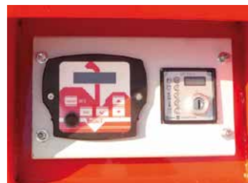
Système « NO STRESS » qui régule la vitesse des ameneurs avec 3 programmes réglables
