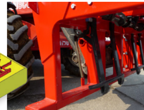
Platte für das auslösen der klemmvorrichtung
