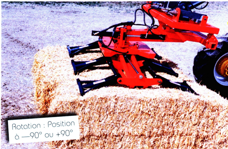
Pivotement grâce au cavage du chargeur pour surélever
