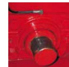
Al igual que en la gama de BPM y OBLX, los yunques son ajustables hidráulicamente desde el puesto del conductor. En caso de un cuerpo extraño, un seguro de paso protege el rotor. En efecto, los yunques están montados en varias partes sobre cilindros acoplados a un amortiguador hidráulico (acumulador de nitrógeno).
