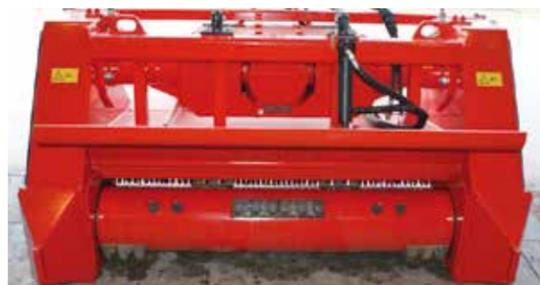
El rotor de acero, de alto límite elástico, es macizo y torneado sobre la misma pieza, las piezas de desgaste (martillos) tienen una disposición helicoidal para una trituración uniforme.
