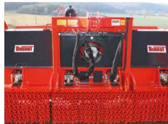
La sensibilidad del seguro de los yunques es controlable y visible desde el puesto del conductor gracias a un manómetro.
