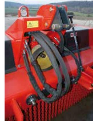
Al igual que en las BPM, la sensibilidad del seguro de los yunques es controlable desde el puesto del conductor gracias a un manómetro. La posición del tercer punto tiene dos posiciones para adaptarse a todos los tractores y conservar un ángulo de transmisión óptimo.
