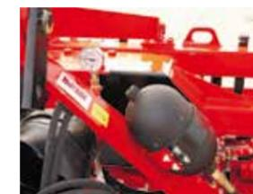
Los soportes de los rodamientos son de acero y llevan incorporados rodamientos a doble hilera de rodillos oscilantes (Ø int. 100 mm); el engrase se efectúa desde el exterior:
