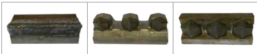
Opcionalmente, 3 tipos de martillos pueden ser montados sobre los rotores de BP y BPE. Los martillos están siempre fijados por dos tornillos (Ø 24 mm).
