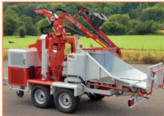
Grue montée sur le broyeur
