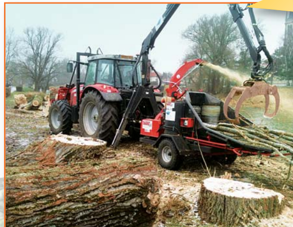
Grue montée sur 3 points tracteur avec entraînement hydraulique
