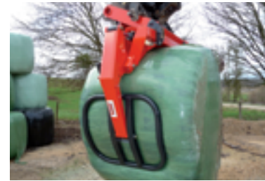
Bauteil passen sich automatisch an den Ballen an, ohne die Folie zu verletzen
