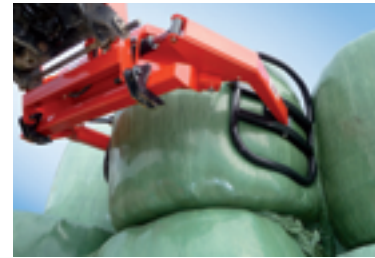
Bauteil passen sich automatisch an den Ballen an, ohne die Folie zu verletzen
