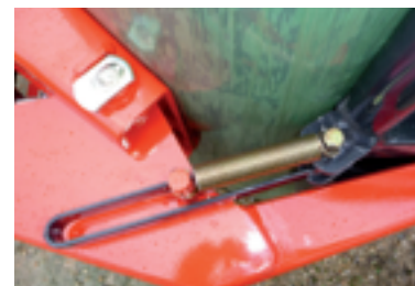
Gelenke der Greifer mit « automatischen Rückruf »
