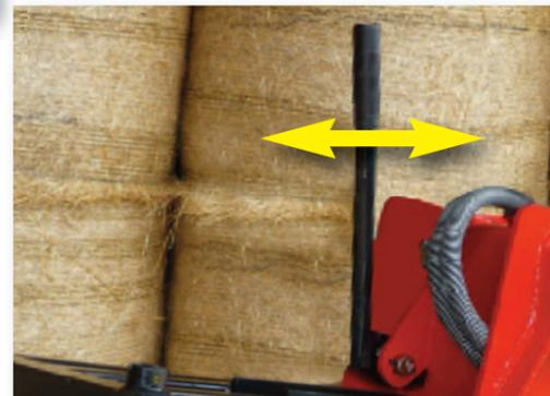
Um die Position zu wechseln muss an dem Griff gezogen werden, wenn der Mast des SYNCHROGRIF 115 in horizontal Stellung ist.
