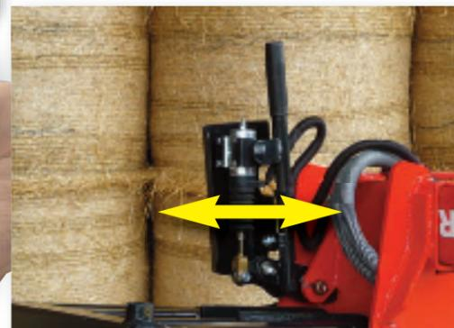
Hydraulisches öffnen der Arme von Arbeitsplatz und Elektro- Verriegelung wenn der Mast des SYNCHROGRIF 115 in horizontal Stellung ist (unmöglich über 20° nach oben).
